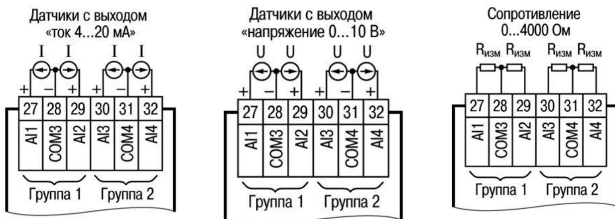
Рисунок 1 – Схема подключения аналоговых датчиков к ПР200
