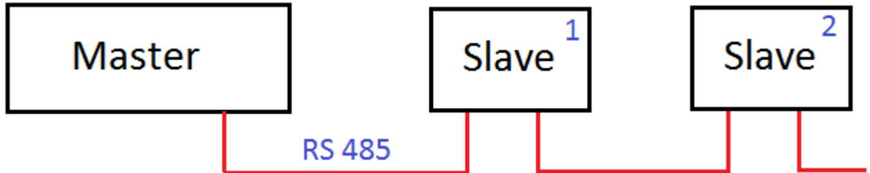
Рисунок 1 – Последовательное подключение по интерфейсу RS485
